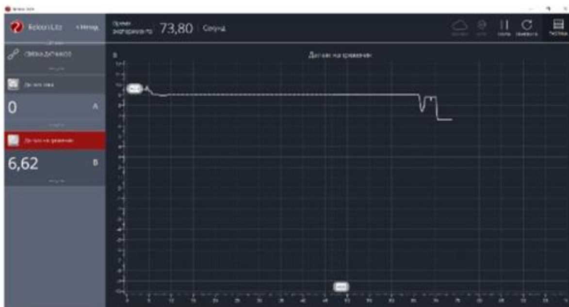
Рис.2. Фрагмент результатов при последовательном соединении, при условии R_1=1000 Ом, U_1=6,62 В
