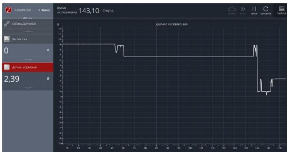
Рис.3. Фрагмент результатов при последовательном соединении, при условии R_2=360 \text{ Ом} , U_2=2,39 \text{ В}
